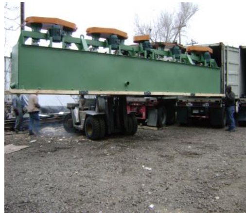
Carga de Banco Spl QPEC de 10 Celdas #18 Spl En el contenedor para enviar a México.
