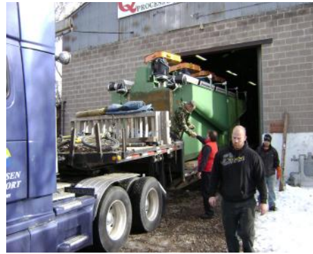
Despacho de Banco de Flotación QPEC de 4 Celdas
