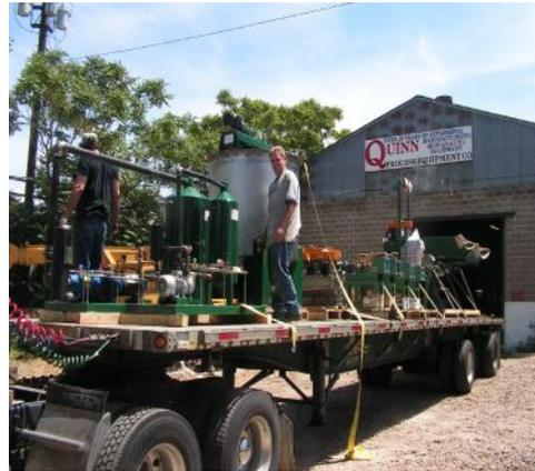
Equipo QPEC de 316ss Filtración & Flotación siendo
