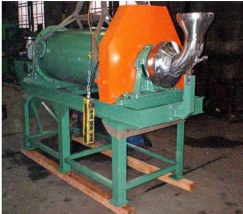
Molino de Bola QPEC 16" x 48" Recubierto con Goma
