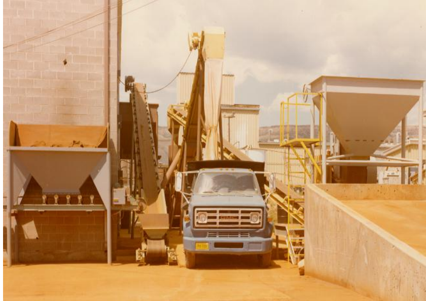
Instalación típica de bandas transportadoras QPEC de 18" en Facilidades de Trituración de Plata Piloto de 2 fases.
