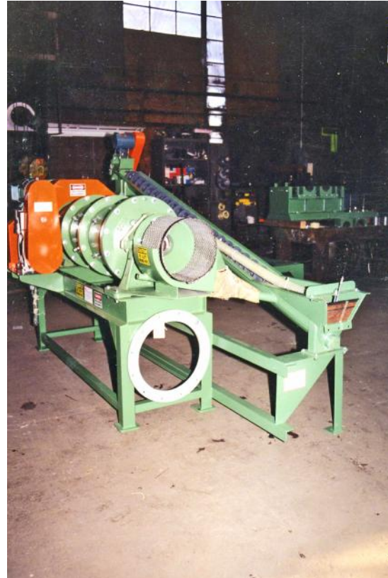
Terminal de descarga del molino con alimentador de Artesa al Clasificador de Espiral
