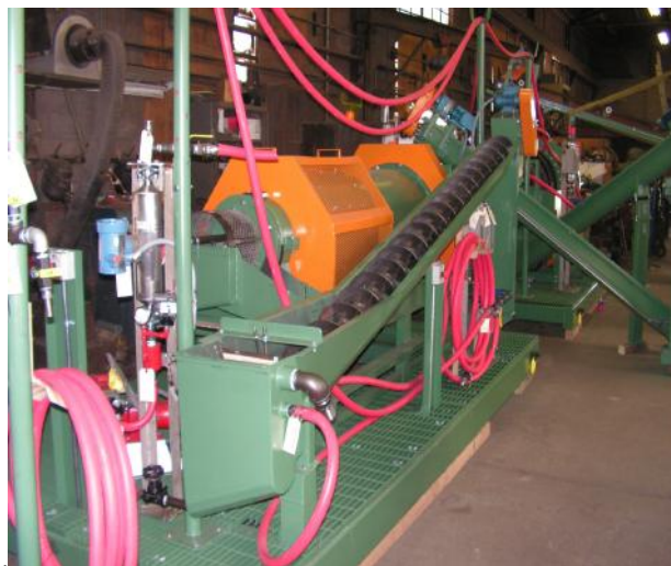
Módulo de Molino QPEC de 24" Circuito Cerrado Clasificador Espiral de 9"
