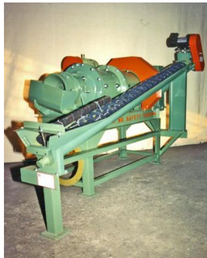
Molino QPEC de 16" x 32" Varilla-Bola en Circuito Cerrado 6" Clasificador Espiral
