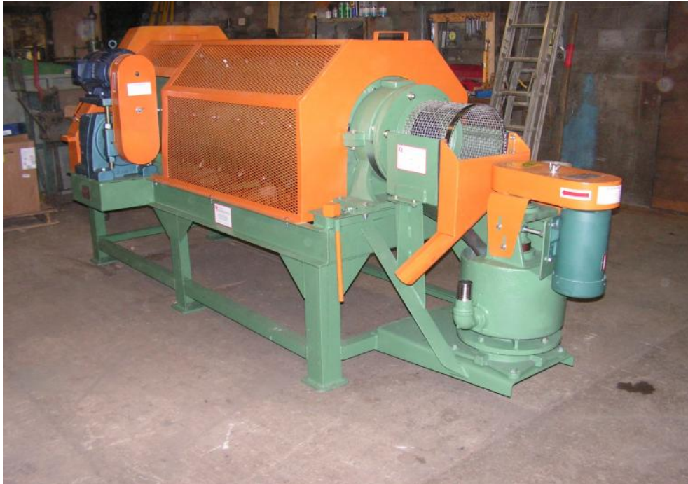
Molino de Bola-Varilla de 24" x 64" con jaula de seguridad y bomba de arena vertical de 1"
