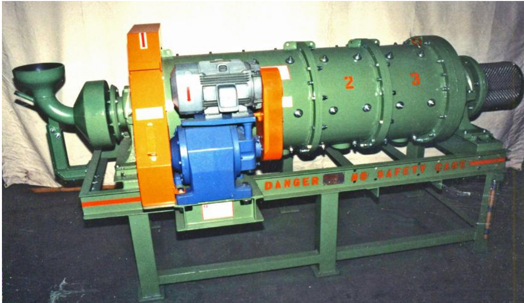
Molino de bola-varilla de 16" de tres secciones de 32" x 48" x 64".
