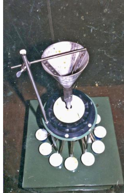
Nota: Placa desviadora "Baffle" estacionaria en embudo de carga
