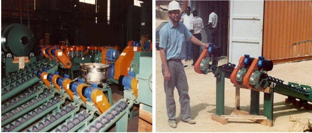
Clasificador Espiral QPEC de 6" con otros equipos diferentes. 3- Clasificadores en Espiral QPEC de 6" en África
