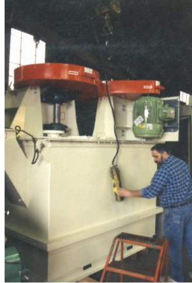
Depurador de Desgaste Duplex de 40" x 40" revestido con placa de goma
