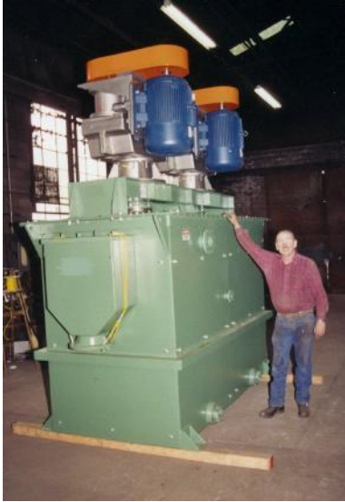
Depurador de Desgaste Duplex de 48" x 48" resistente a la abrasión
