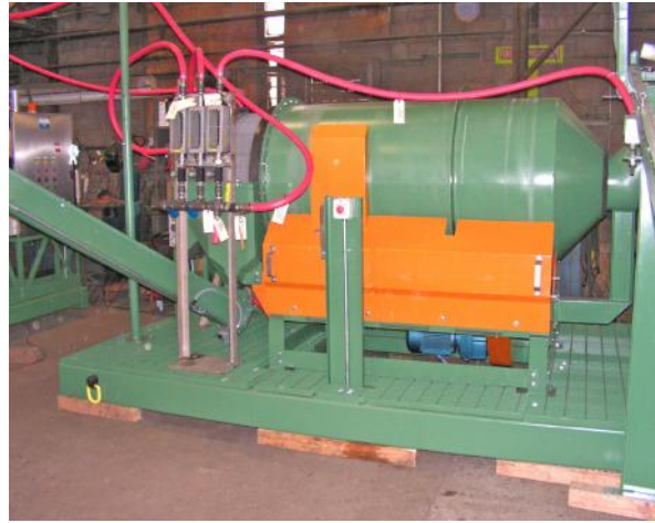
QPEC 30" x 48" Depurador Trómel Revestido de Goma Montado sobre Patín Eléctrico & Tubería
